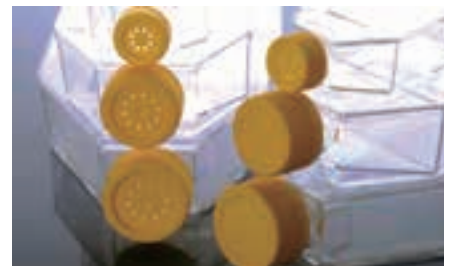
浮遊細胞用フラスコのキャップは黄色で識別可能
