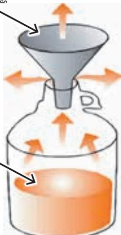
蒸発する液面の面積が大きく、廃液タンクの中に充満
