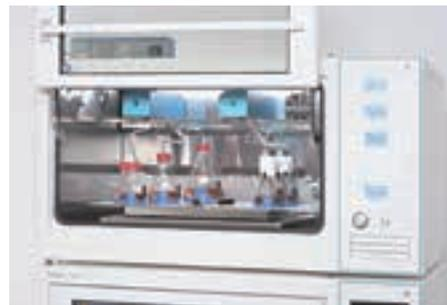
Kuhner インキュベーターシェーカーで培養中の最大16本のフラスコの酸素移動速度 (OTR)、二酸化炭素移動速度 (CTR)、呼吸商 (RQ) をオンライン測定します。プロセス開発においてより効率的で最適な条件検討をご提供します。様々なタイプや容量のフラスコに対応し、設置も容易です。
