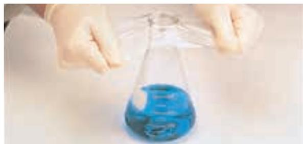
デュラシールを容器の口にあてがい左右に伸ばしてから下に引いて容器にくっつけ、次に前後に伸ばし同じように下に引いて容器にくっつけて下さい。
