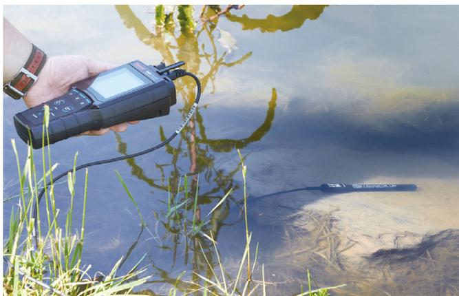
ポータブルタイプのOrion Star A220/A320シリーズは、野外での利用に耐える防水性を備え、多くのデータを内蔵メモリーに保存でき、野外での長期モニターに利用できる特別なシステムです。
