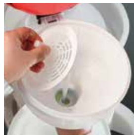
取り外し可能なネットで固形物やスターラーバーをキャッチします
